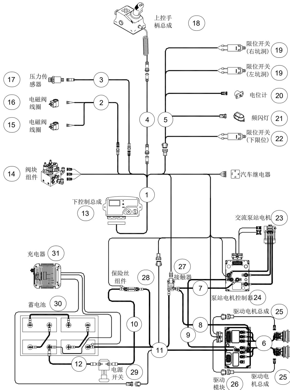
**502.1 电气线束（电机驱动）（铅酸电池）**
